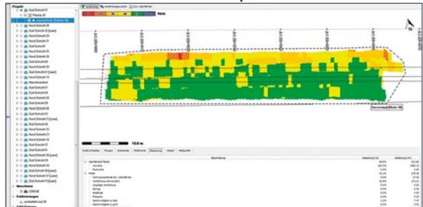
La principale fonction de Q Pave est d'enregistrer le bilan de température. Outre la fonctionnalité centrale Pave Navigator, le capteur de température de surface, le système est capable de gérer un grand nombre de mesures de température additionnelles ainsi que la largeur du régleur.
